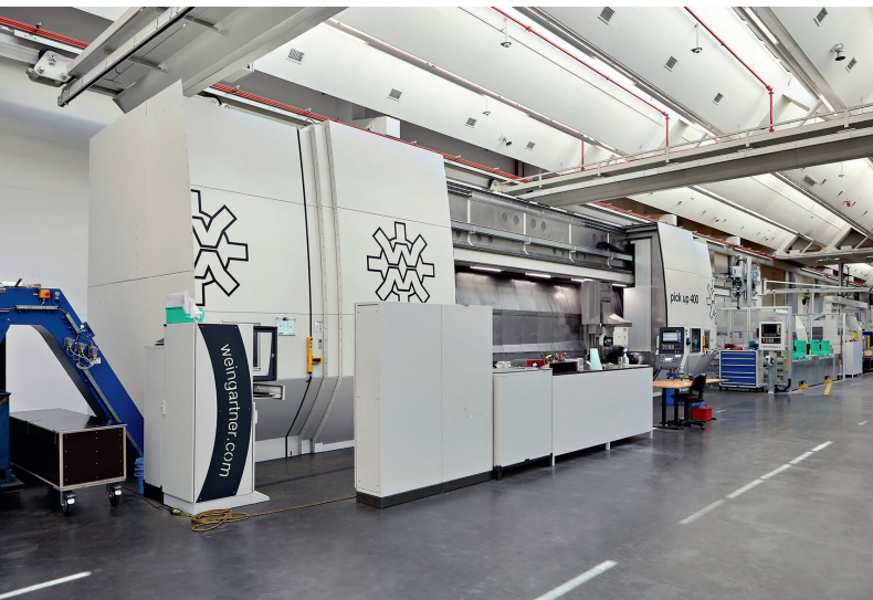
4 Das Drehfräszentrum der Baureihe pick up 400 von Weingärtner ist speziell für die vollautomatische Fertigung von Schnecken für Spritzgießautomaten konzipiert © Arburg
