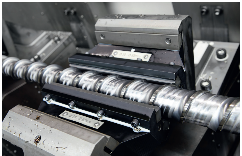
5 In die neue pick-up-Baureihe sind spezifische Stärken der pick-up-classic-Baureihe eingeflossen; so auch das Spannkonzert mit Prismenbackenlünetten © Arburg
